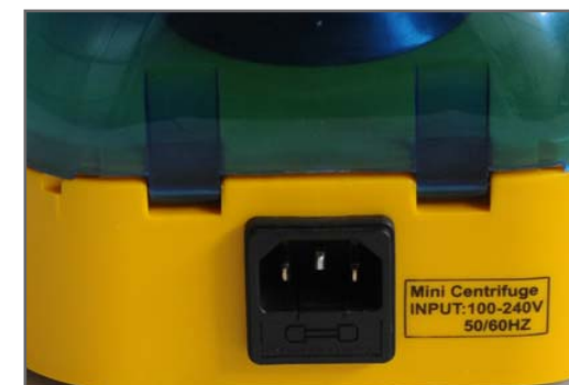
Detalle de la toma de corriente
