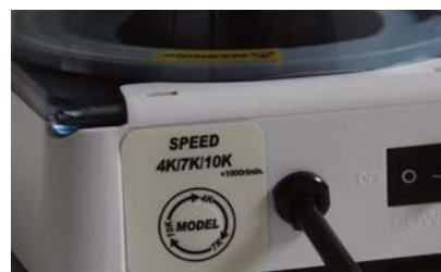
Referencia / Code 52507015 Botón selector de velocidad, en la parte trasera Speed button, back of the equipment
